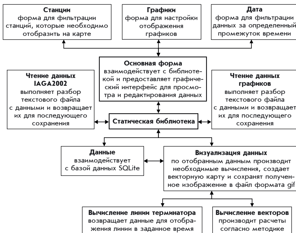
Рис. 1. Блок-схема структуры программы расчета векторов эквивалентных ионосферных токов
